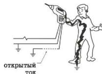
При достаточной силе тока утечки срабатывает плавкий предохранитель. Но заземление должно быть достаточно надежным.
